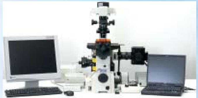
Configuración con el sistema de imagen confocal Nikon C1, Epi-FI y sistema TIRF
